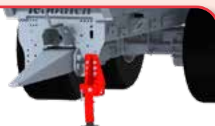
Hydrauliczna składana podpora mocowana bezpośrednio do ramy wywrotki, co uwalnia dyszel i ułatwia skręt.
