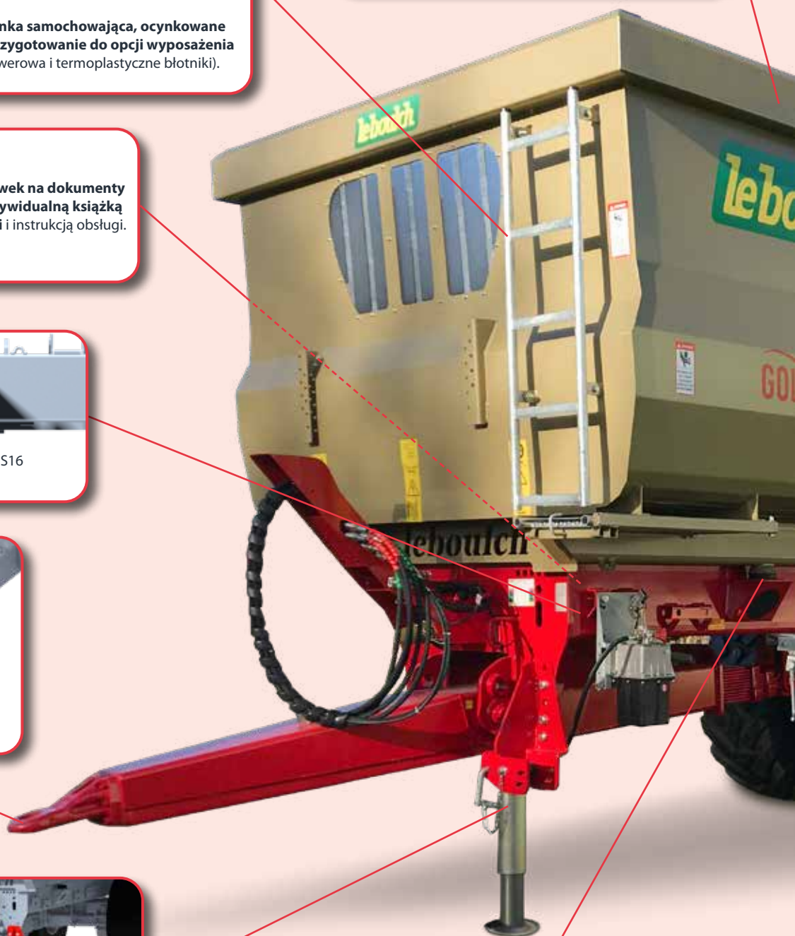
Oczka pociągowe do wyboru (A) Przykręcane \varnothing 50 mm (w standardzie) (B) Przykręcane kuliste (w opcji)
